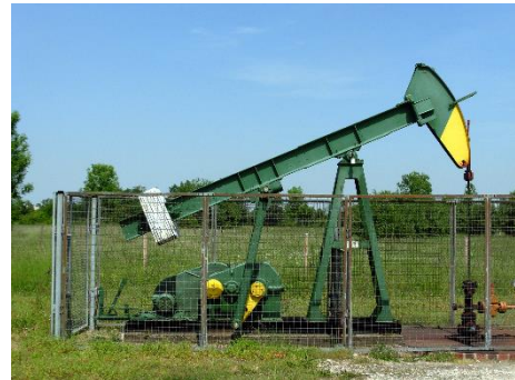
Erdöl wird mit Hilfe von Pumpen an die Erdoberfläche befördert. © Lluís tgn
